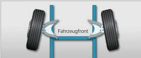
Spur nach innen bezieht sich auf die Neigung der Räder eines Fahrzeugs, sodass die beiden Vorderräder (von vorne gesehen, siehe Abbildung links) näher aneinander sind als die Hinterräder.
